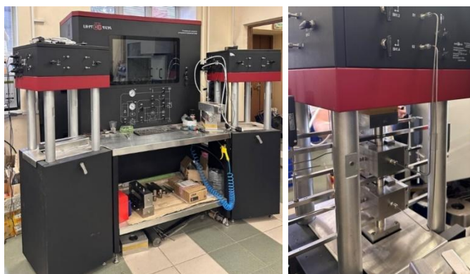
Рис. 1. Установка определения проводимости пропантной пачки
