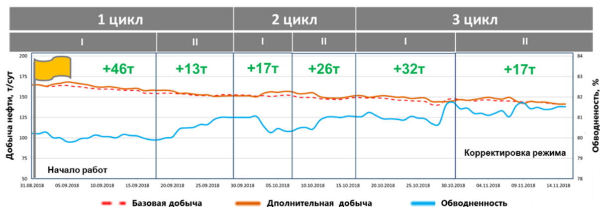
Рис. 6. Динамика добычи нефти и обводненности при проведении нестационарного заводнения
