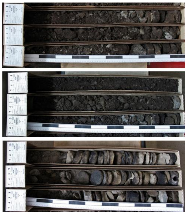
Рис. 2. Керн скв. **288, бобриковский горизонт. 1-й ящик - следы биотурбации (ходы Planolites ); 2-й ящик - массивная текстура, первичная слоистость уничтожена биотурбацией; 3-й ящик - углистые прослои в кровельной части, характерные для прибрежно-аллювиальной обстановки. Масштаб 5 см
