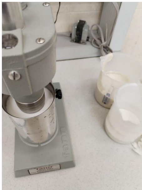
Рис. 2. Ротационный вискозиметр марки Fann 700
