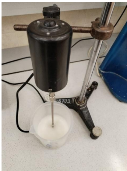
Рис. 1. Размешивание раствора с помощью миксера Fann 700
