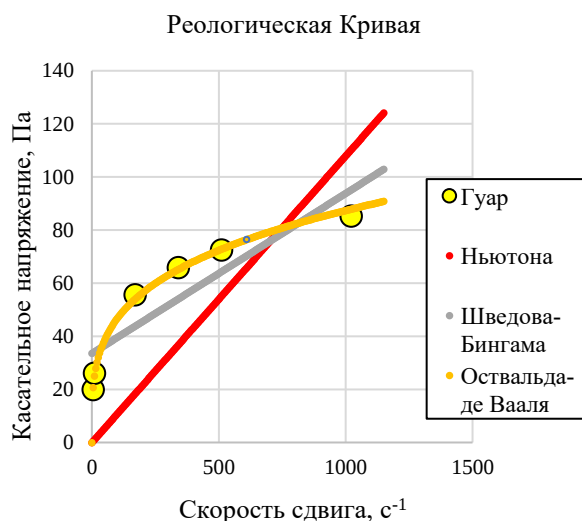
Рис. 36. Реологическая кривая гуара в буровом растворе при концентрации 10 г/л
