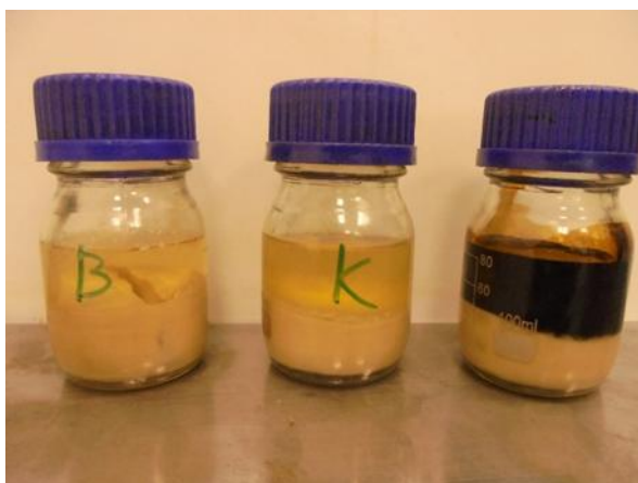
Рис. 3. Состояние контакта БНЭ с минерализованной водой, соляной кислотой (24 %) и нефтью (в течение 24 ч)
