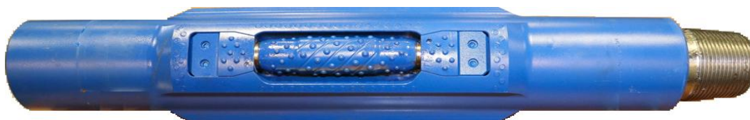
Рис. 3. Шарошечный калибратор KP2-215,9 СТ.П-133-133
