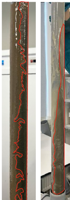
Рис. 3. «Языковое» движение цементного раствора при вытеснении РУО (слева) и РВО (справа) (контур языка выделен красным цветом)
