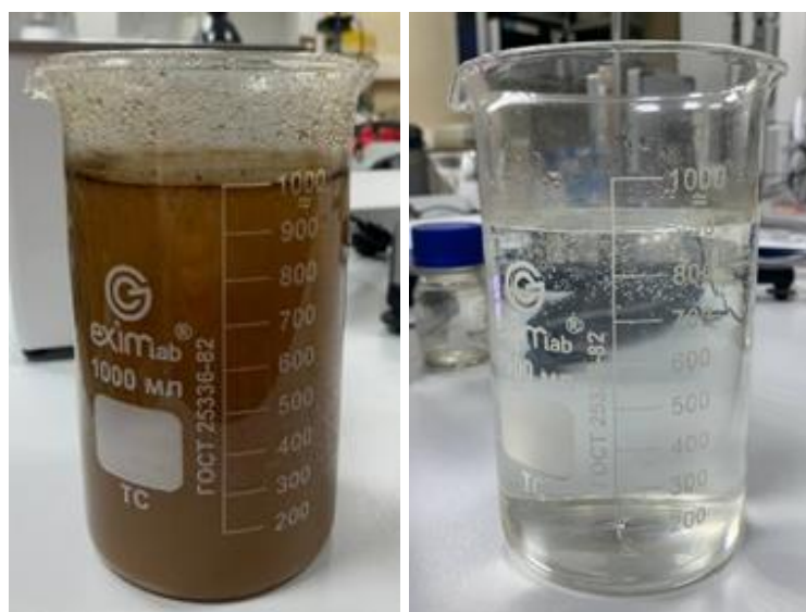
Рис. 5. Образцы: исходная смесь (500 мг/л) (слева) и смесь после очистки через олеофобные частицы (справа) (9 мг/л)
