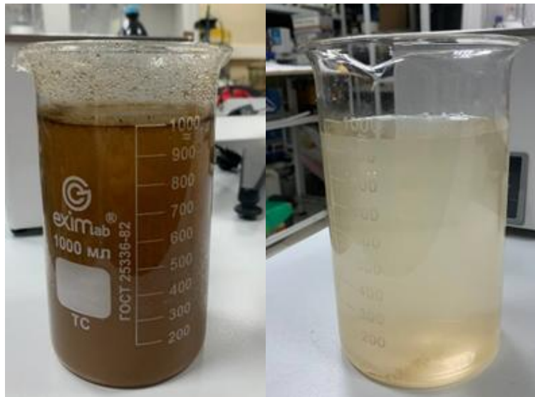
Рис. 6. Образцы: исходная смесь (500 мг/л) (слева) и смесь после очистки через кварцевый песок (справа) (59 мг/л)
