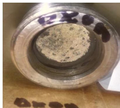
Рис. 3. Внешний вид насыпной модели после окончания эксперимента с гидрофобизированным торфяным сорбентом
