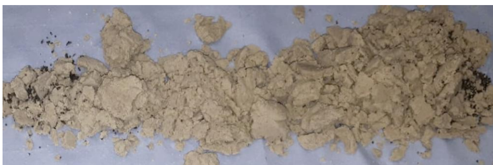
Рис. 3. Внешний вид насыпной модели после окончания эксперимента с гидрофобизированным торфяным сорбентом
