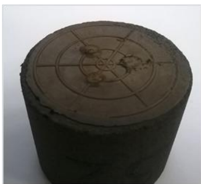
Рис. 3. Внешний вид насыпной модели после окончания эксперимента с гидрофобизированным торфяным сорбентом
