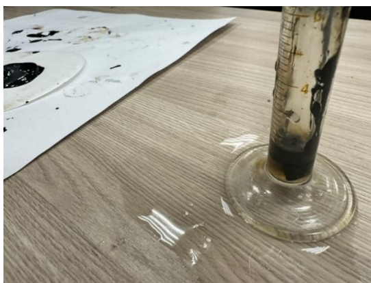
Рис. 4. Образец нефтешлама в колбе после водяной бани
