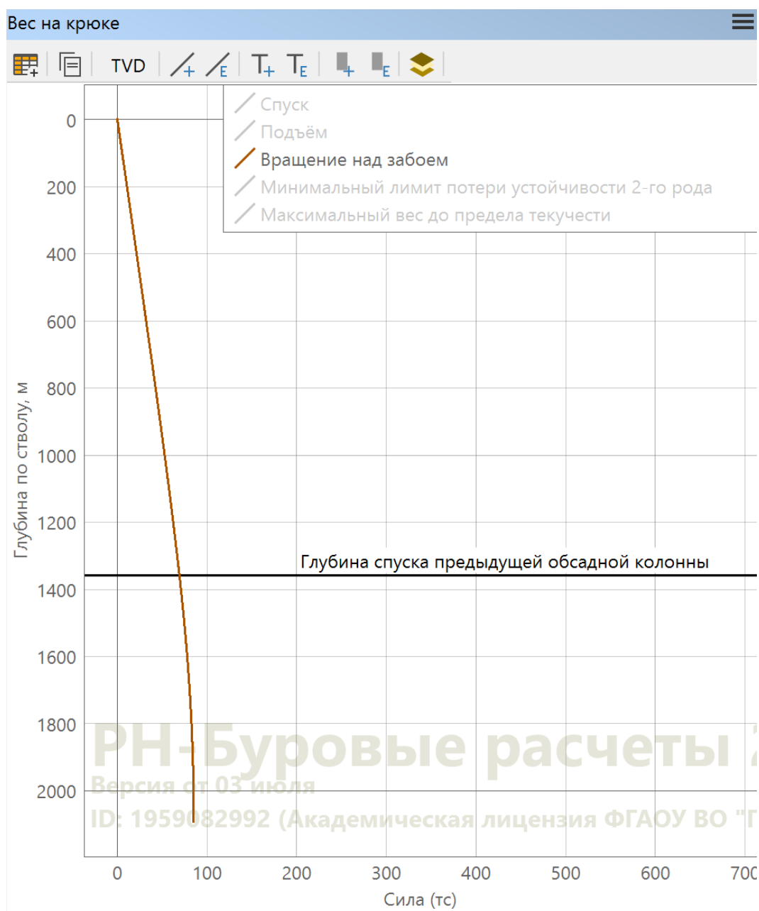
Рис. 4. Эюра веса на крюке при вращении обсадной колонны при цементировании в ПК «РН-Буровые расчеты»
