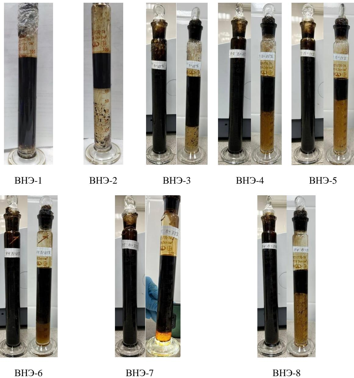
*Рис. 1. Лабораторные исследования эффективности деэмульгаторов*
