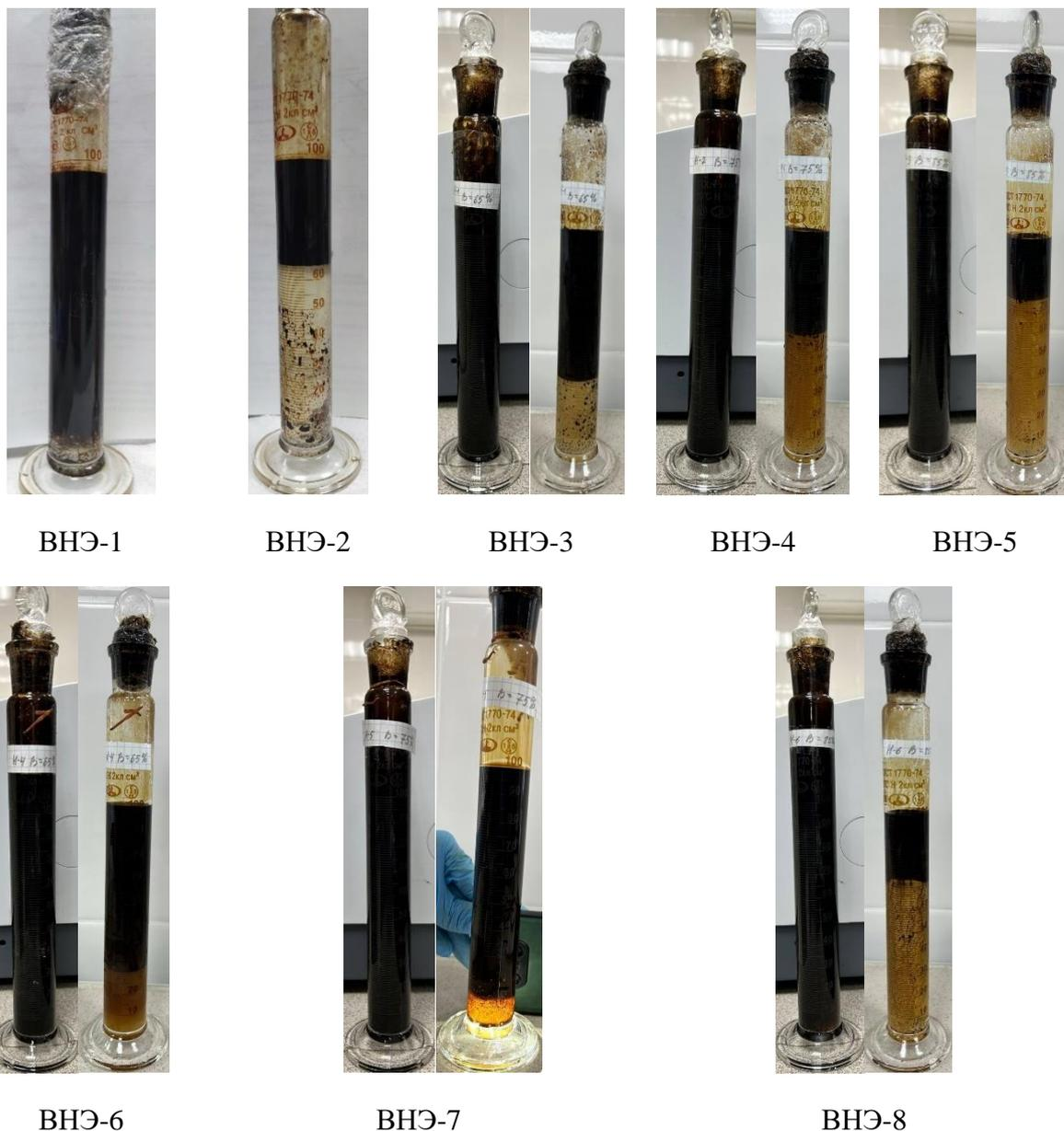
*Рис. 1. Лабораторные исследования эффективности деэмульгаторов*
