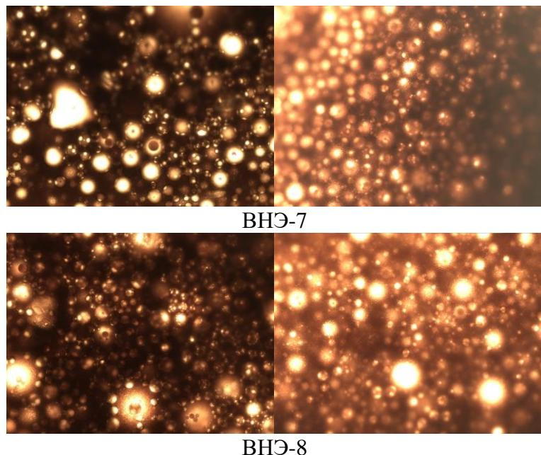
*Рис. 3. Микрофотографии проб до и после дозирования деэмульгатора ДЭ-2*
