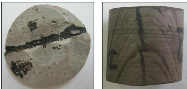
**Фото 1. Трещина, заполненная высоковязкой нефтью и битумом
