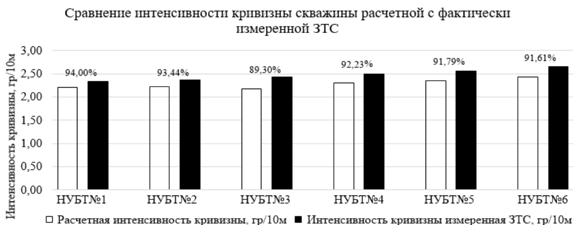
Рис. 9. Сравнение интенсивности кривизны скважины, полученных при бурении 125 скважин с расчетными на базе моделирования программы-тренажера
