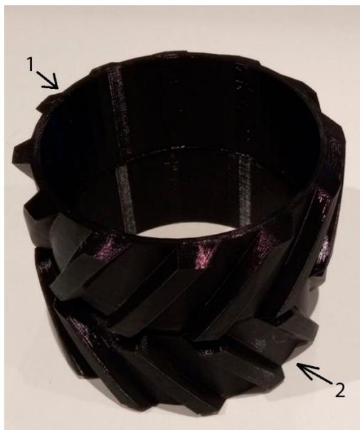
***Рис. 2. Центратор-турбулизатор для бурильных труб изготовленный с применением FDM печати из инженерного полимера.***
