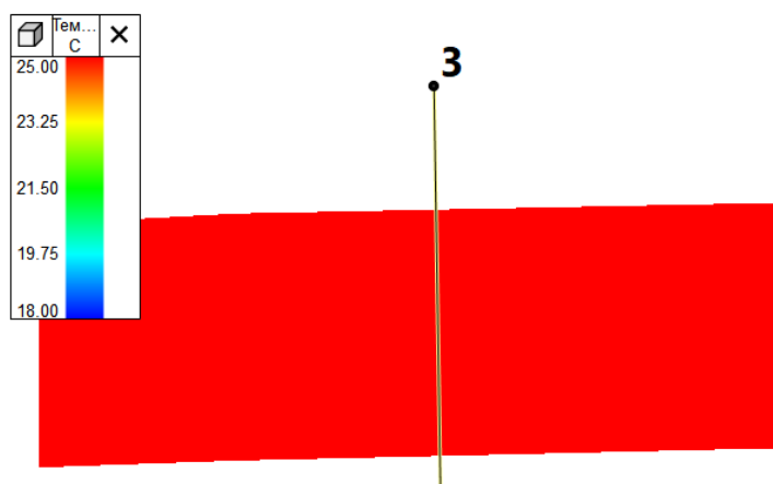
Рис. 15. Распределение температуры в окрестности скв. 3 при закачке воды с температурой 18°C на конец истории – 01.01.2024
