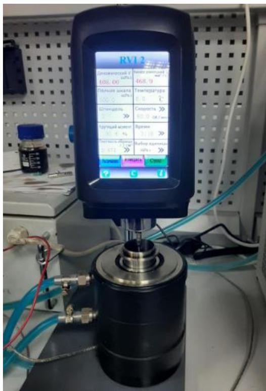
**Рис.5. Вискозиметр RVI 2**
