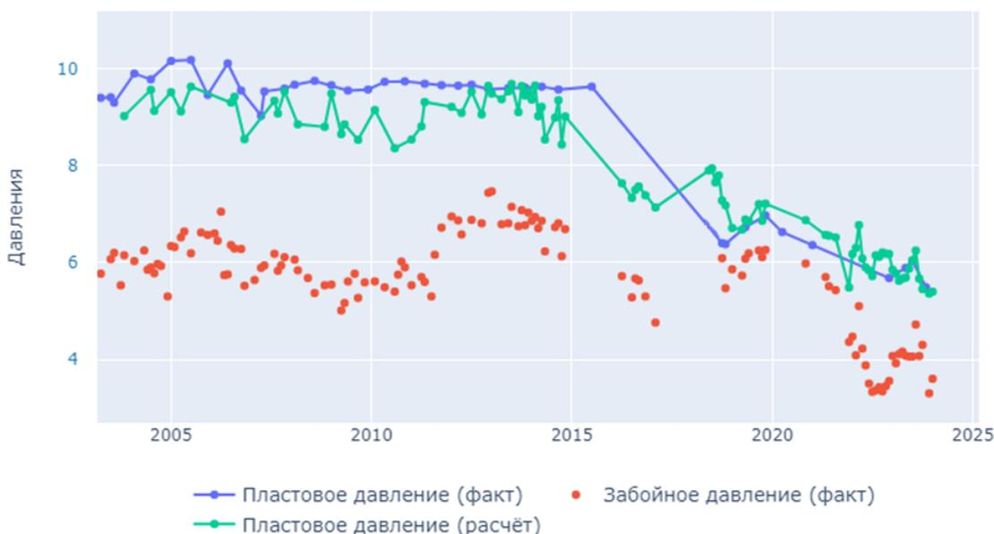
**Рис. 8. Сопоставление динамики фактического и расчётного пластового давлений по одной из скважин**
