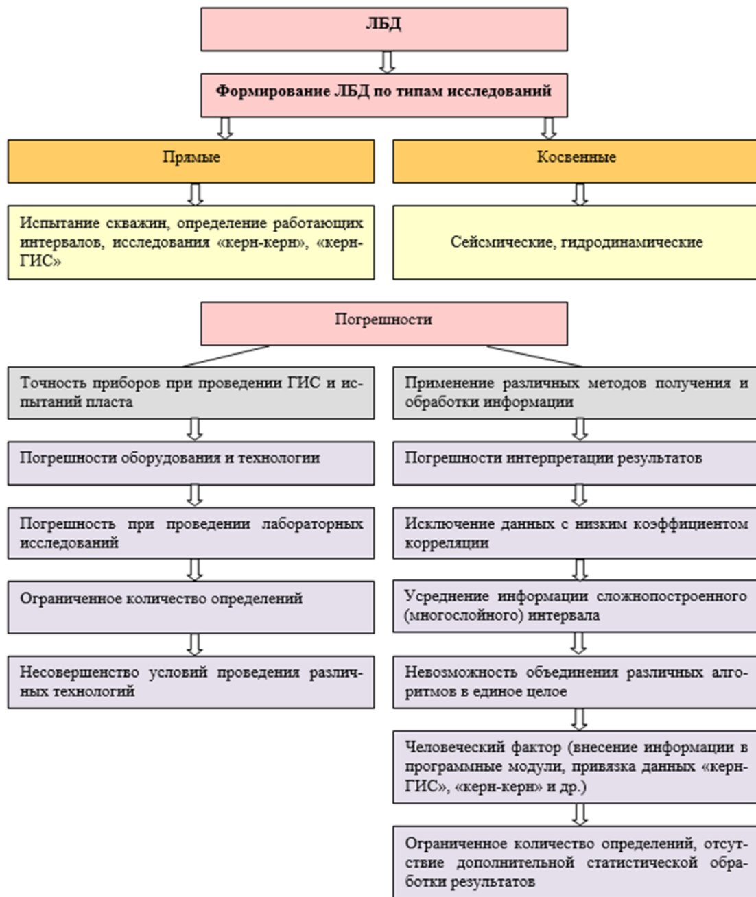
Рис. 2. Алгоритм выявления погрешностей для формирования локальной базы данных (ЛБД) и последующего моделирования сложнопостроенных залежей
