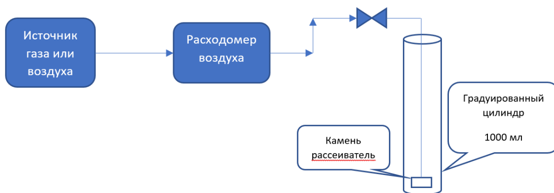
Рис. 6. Схема теста с барботированием в цилиндре.
