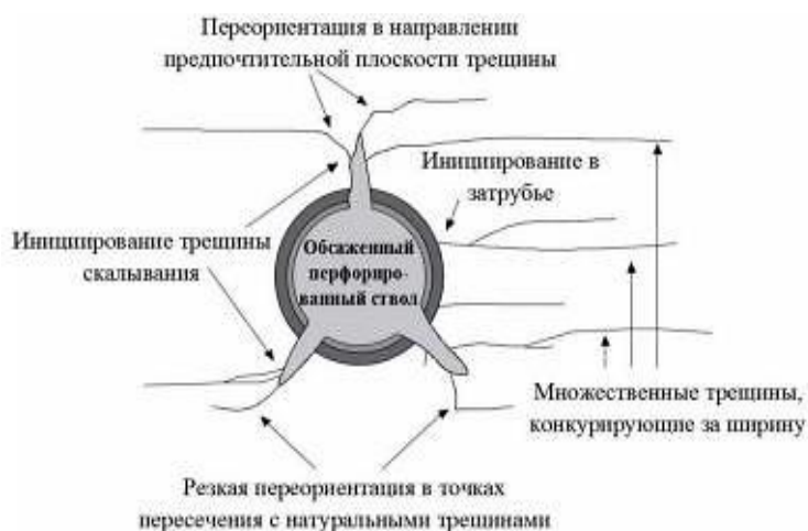
Рис. 1. Трещины, образуемые в породе в ходе проведения ГРП
