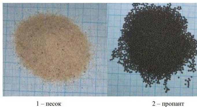
Рис. 3. Материал, используемый для заполнения трещины при проведении гидроразрыва пласта
