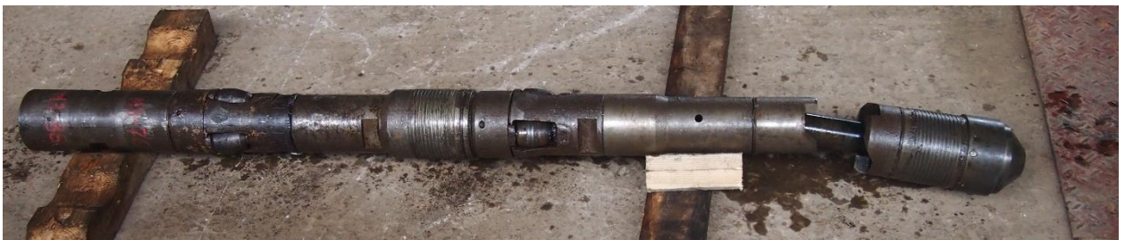
Рис. 10. Башмак извлекаемый с посадочной «головкой» и развальцевателем, извлеченный из скважины 60*** Гремixinского месторождения ОАО «Удмуртнефть» им. В.И. Кудинова после установки ПП
