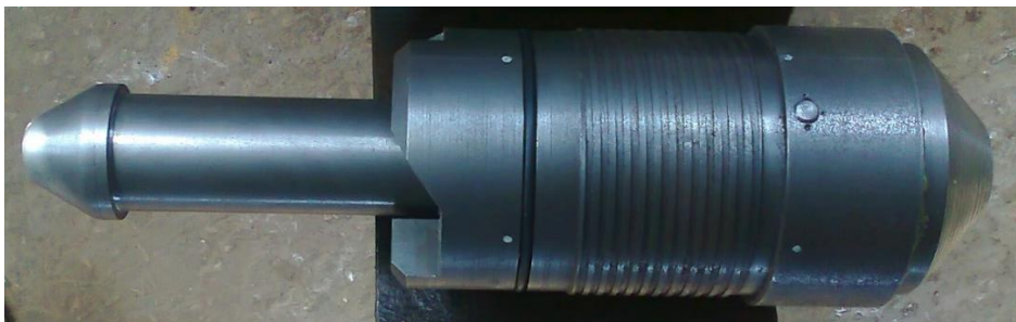
Рис. 8. Башмак извлекаемый для ПП, позволяющий производить промывку скважины, закрывающийся с упором на забой
