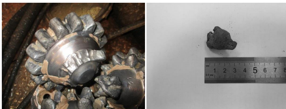
Рис. 1. Шарошка со сломанными зубьями ряда 2
