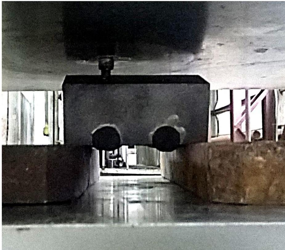
*Рис. 3. Модель корпуса опытного долота с припаянными резцами PDC в процессе создания усилия прессом для вырывания резца*
