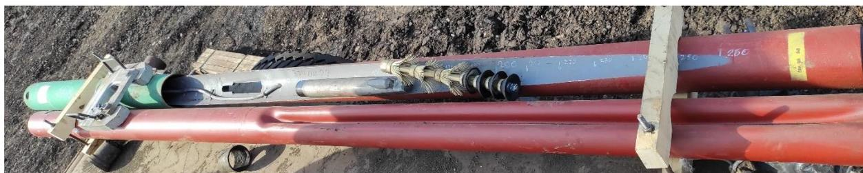
**Рис. 8. Извлекаемый клин-отклонитель ОИ-168 конструкции ТатНИПИнефть**
