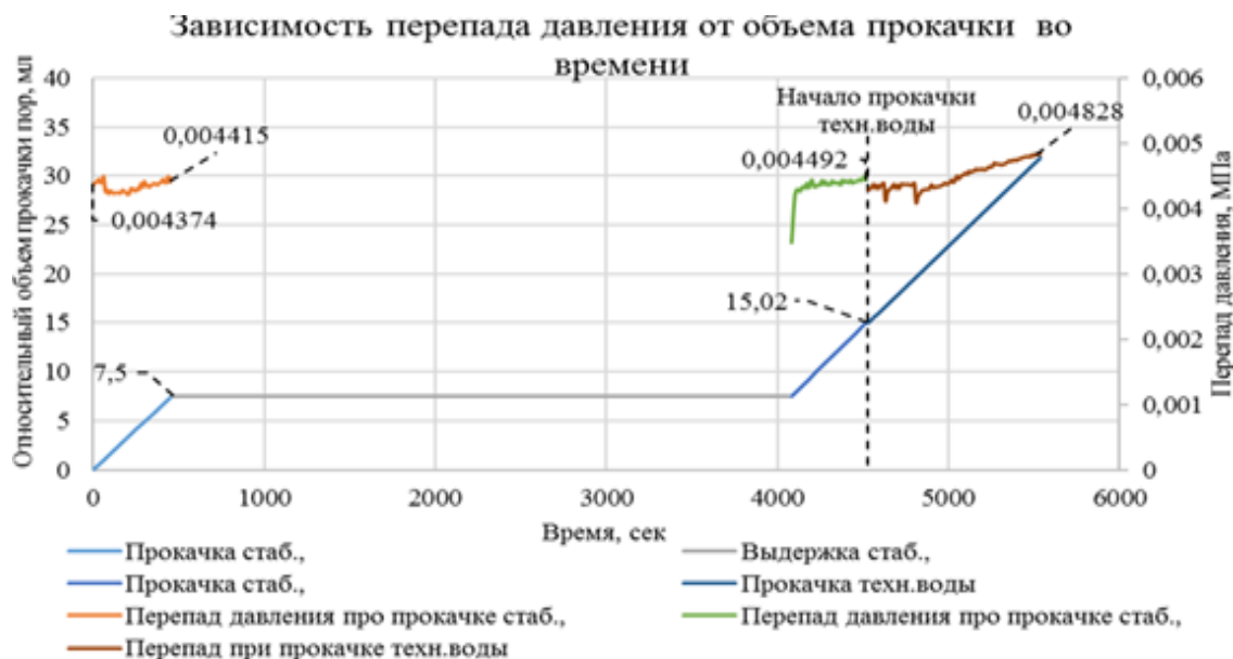
Рис. 1.3. График зависимости перепада давлений от относительного объема прокачки во времени раствора стабилизатора глин и технической воды при температуре 40°C
