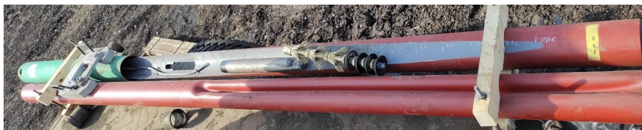
Рис. 8. Извлекаемый клин-отклонитель ОИ-168 конструкции ТатНИПИнефть
