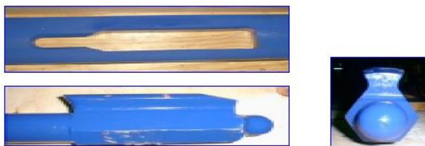
Рис. 3. Вид выборки в желобе клина и ловильного крюка компании Baker Hughes
