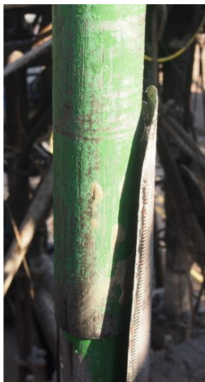
Рис. 6. Голова клина в прижатом зафиксированном положении к стволу съёмника в процессе извлечения из скважины
