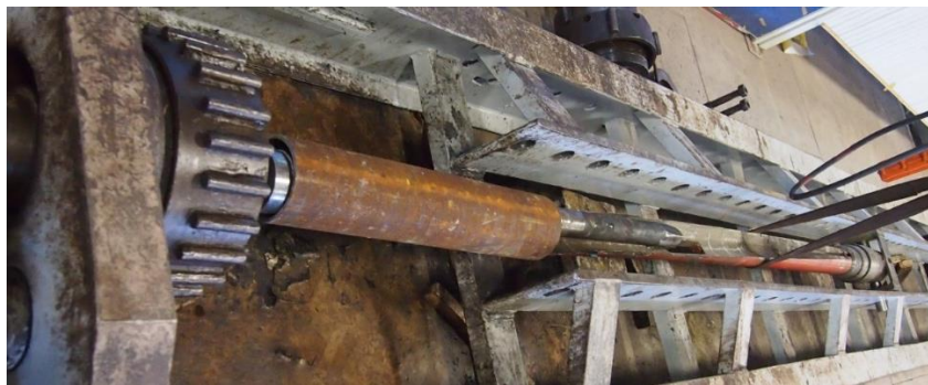
Рис. 5. Модели клина-отклонителя и съёмника, установленные на горизонтальном прессе
