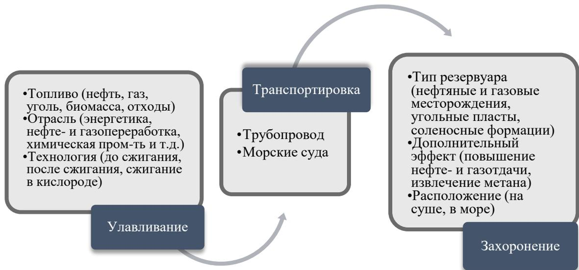
*Рис. 2. Схема движения газа CO<sub>2</sub>*
