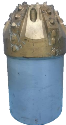
Рис. 2. Шести-лопастная бурильная головка типа «6 ЛБК»-«МСЗ»
