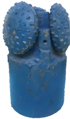
Рис. 1. Трехшарошечная бурильная головка типа «6 ВК»-«СЗ»
