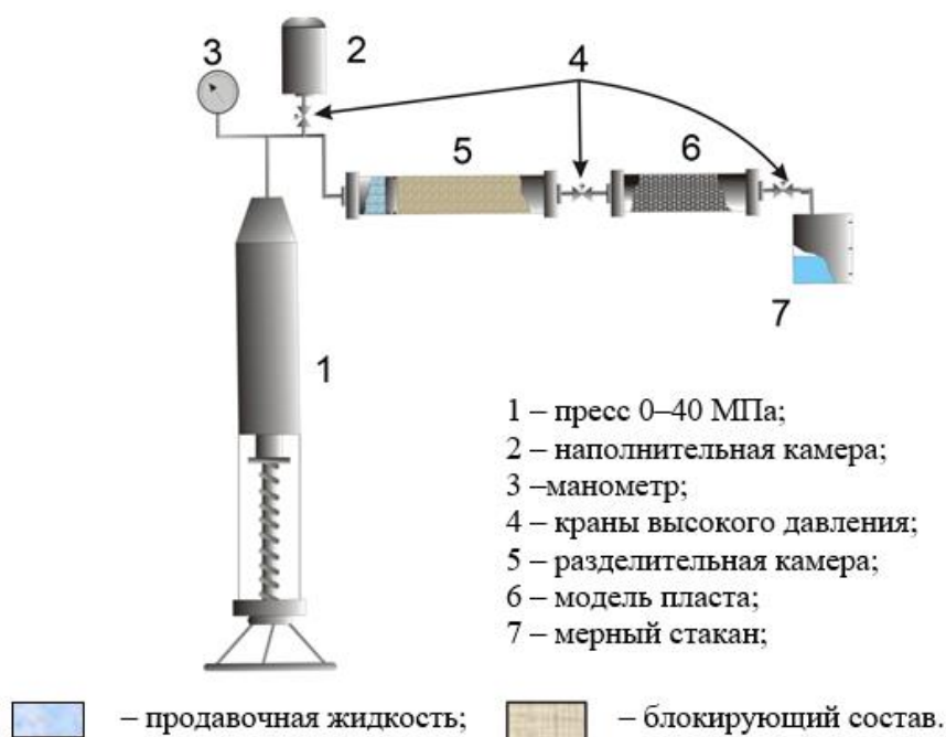
Рис. 1. Установка для определения закупоривающей способности блокирующего состава
