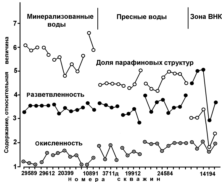
Рис. 2. Влияние типа заводняющего агента на состав экстрактов остаточных нефтей из пластов верхнего девона (горизонт Д 1 ) [10]
