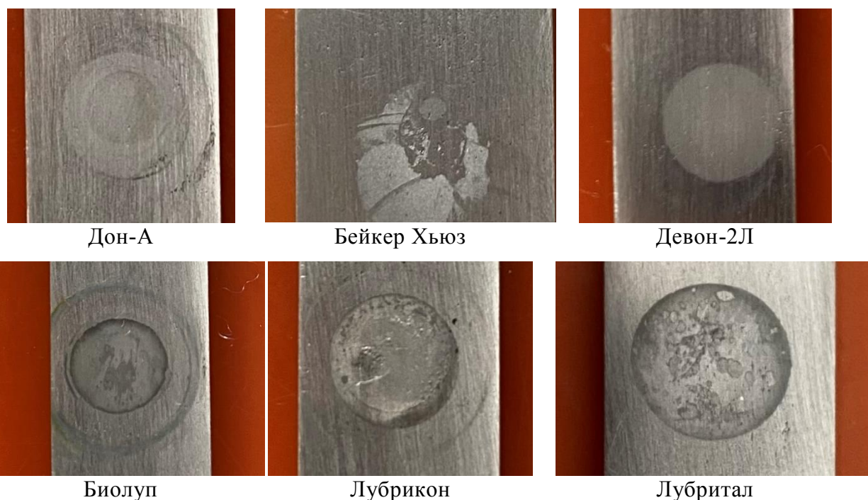
Рис. 12. Коррозионные поражения Ст3 в модели пластовой воды (АОИК), с добавлением реагентов
