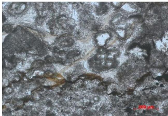
Б. Образец пласт S<sub>1</sub>fl, гл. 3831,75 м ув. 100х.
