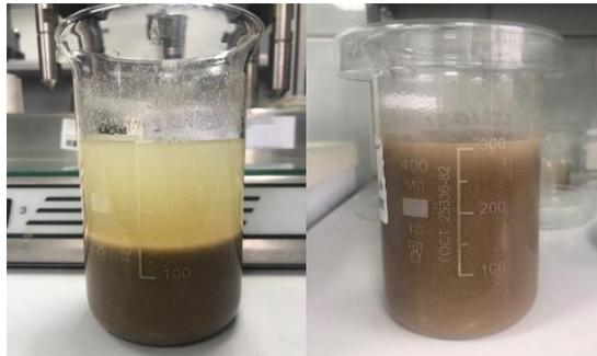
**Рис. 5. Катионный буровой раствор: после нахождения в состоянии покоя в течение 1 месяца (слева), после перемешивания (справа)**
