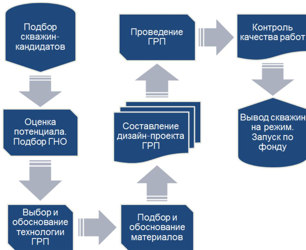
**Рис. 3. Последовательность процессов при планировании и выполнении ГТМ (ГРП)**
